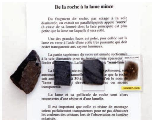
Ce kit permet à l'élève de comprendre la fabrication d'une lame mince à partir d'une roche, il comprend :
