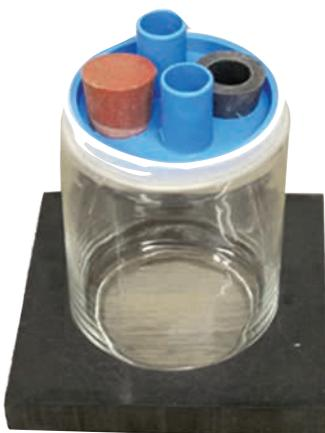
Forme cylindrique - La hauteur de l'enceinte en verre met les sondes à l'abri des rongeurs. L'enceinte en verre permet une désinfection parfaite sans crainte des agents chimiques.
