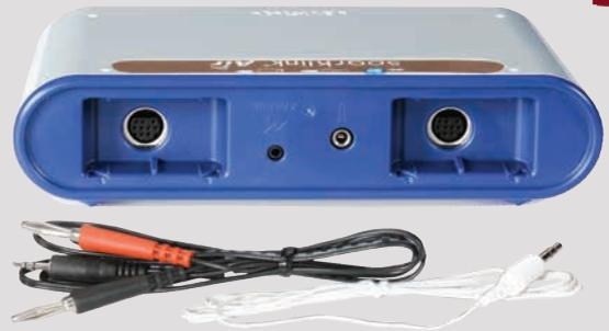
L'interface sans fil Sparklink Air possède deux ports permettant la connection de un à deux capteurs. Deux ports supplémentaires sont dédiés pour des mesures de température (sondes fournies). Cette interface communique avec votre équipement (ordinateur ou tablette) par Bluetooth ou câble USB.
