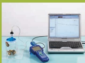
> Connectée à un ordinateur, l'interface GLX est une interface fixe : l'écran intégré est inactif, elle sert de lien entre les capteurs et l'ordinateur,
