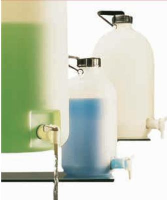
Idéal pour stocker l'eau déminéralisée ou tout autre liquide. Modèle économique en polyéthylène haute densité. Paroi épaisse, très résistant. Robinet interchangeable. Température d'utilisation : -50°C à 80°C. Robinet en polyéthylène, bouchon à vis et poignée de transport.
