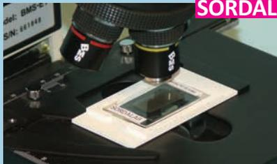
Ce support permet d'utiliser les lames minces de roches (45 x 30 mm) avec un microscope à surplatine à chariots. Ce support en plastique blanc de dimensions extérieures 76 x 40 mm possède un trou central de 40 x 26 mm.
