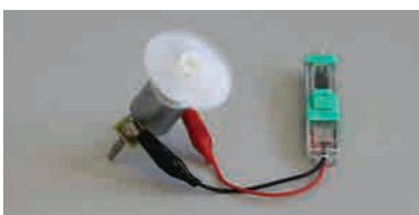
Décharge du condensateur dans un moteur à hélice
